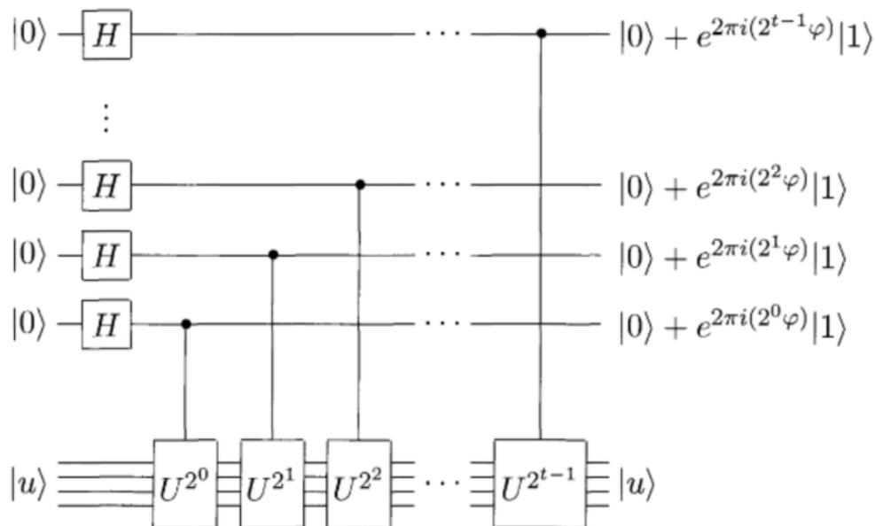
Застосуємо  $t$  операцій  $C_k = C_{[t-k],(t+1\dots t+n)}(U^{2^k})$ ,
