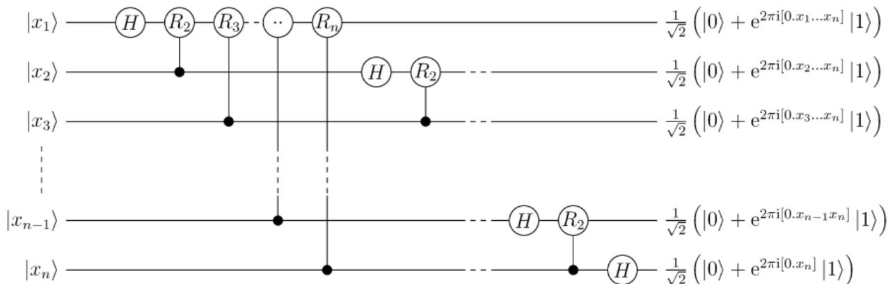
Ця схема задає перетворення  $|x_1 \dots x_n\rangle \longrightarrow |y_n\rangle \dots |y_1\rangle$ .
